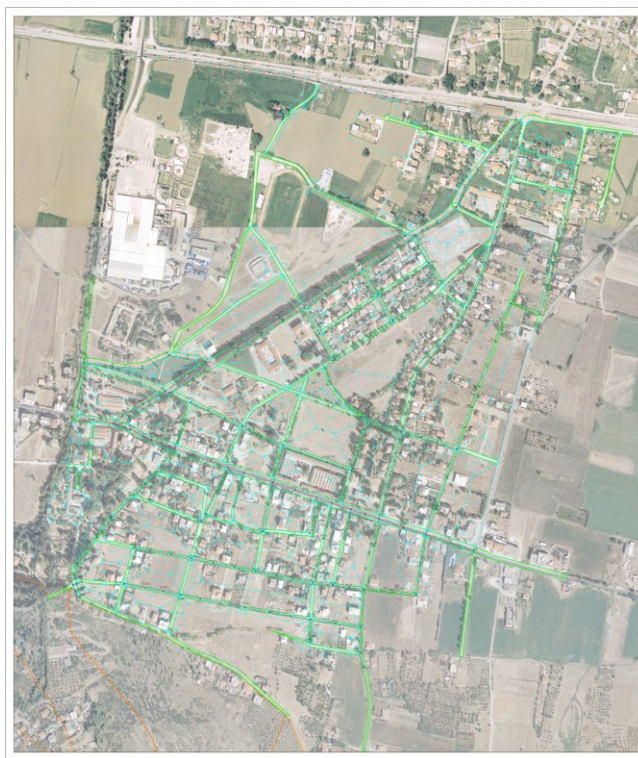
Εικ. 16 Υφιστάμενο δίκτυο αποστράγγισης ομβρίων για το τμήμα του οικισμού ανάντη του Σιδηροδρομικού δικτύου κατασκευασμένο από το πρόγραμμα "Αντώνης Τρίτσης"
